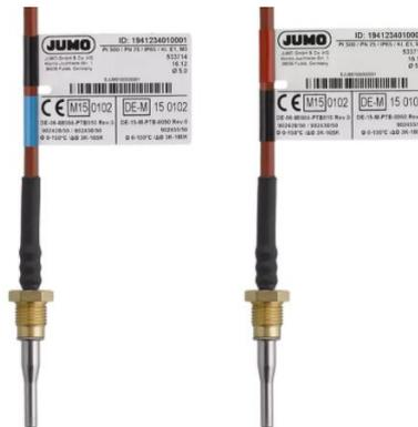
Bei der Zählergröße Qp1,5 müssen die Temperaturfühler direkt in das Medium eintauchen.
